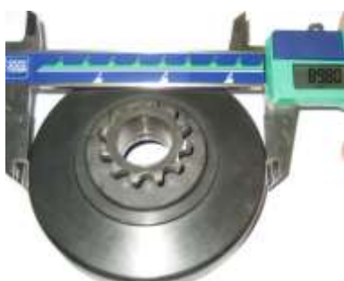
13.33. Diameter måles lige efter skulderen på skålen og ikke på den åbne side af skålen. Minimum diameter: 89,50 mm
