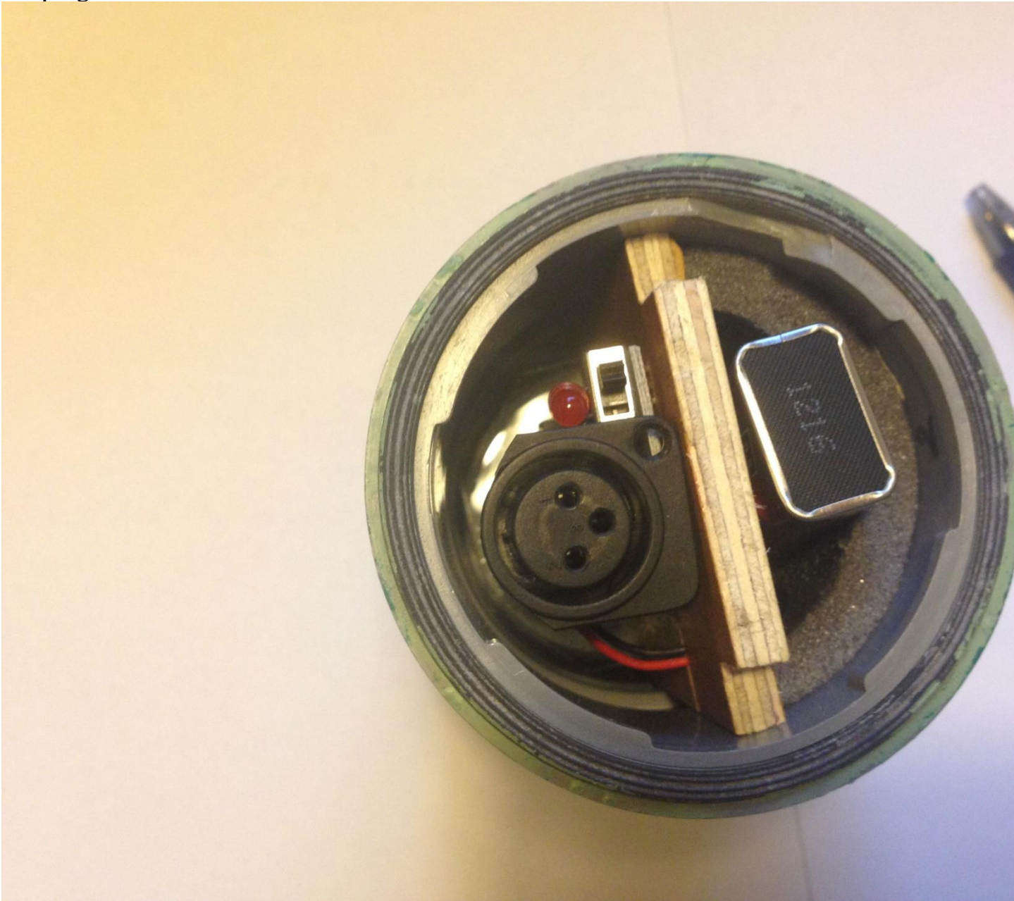
Figur 2 Tracker set fra bunden med låg skruet af
